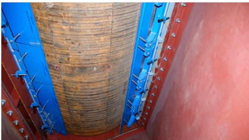
KOMATI-Dichtsysteme für Rostwalzen in der MVA EGK Krefeld, Ersatzkessel 2 Inbetriebnahme 2011
